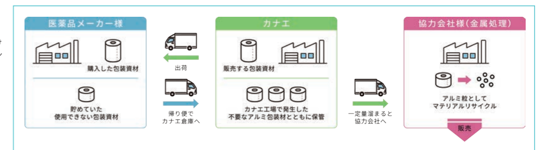
(図2) PTP 包装蓋材向けアルミ箔リサイクルの取り組みフロー
